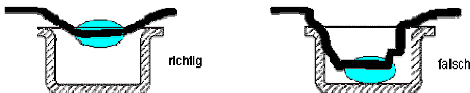
Abb. 2: Richtiges und falsches Einlegen der Pille in das Quarzschälchen.
